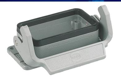
No. parte 09 30 016 0307 Carcasa adicional, tamaño: 16 B, diseño bajo, palanca única, policarbonato (PC), acero inoxidable, material de la carcasa: aluminio fundido a presión, lacado en polvo, RAL 7037 (gris polvo), material de la junta: NBR, grado de protección: IP65
